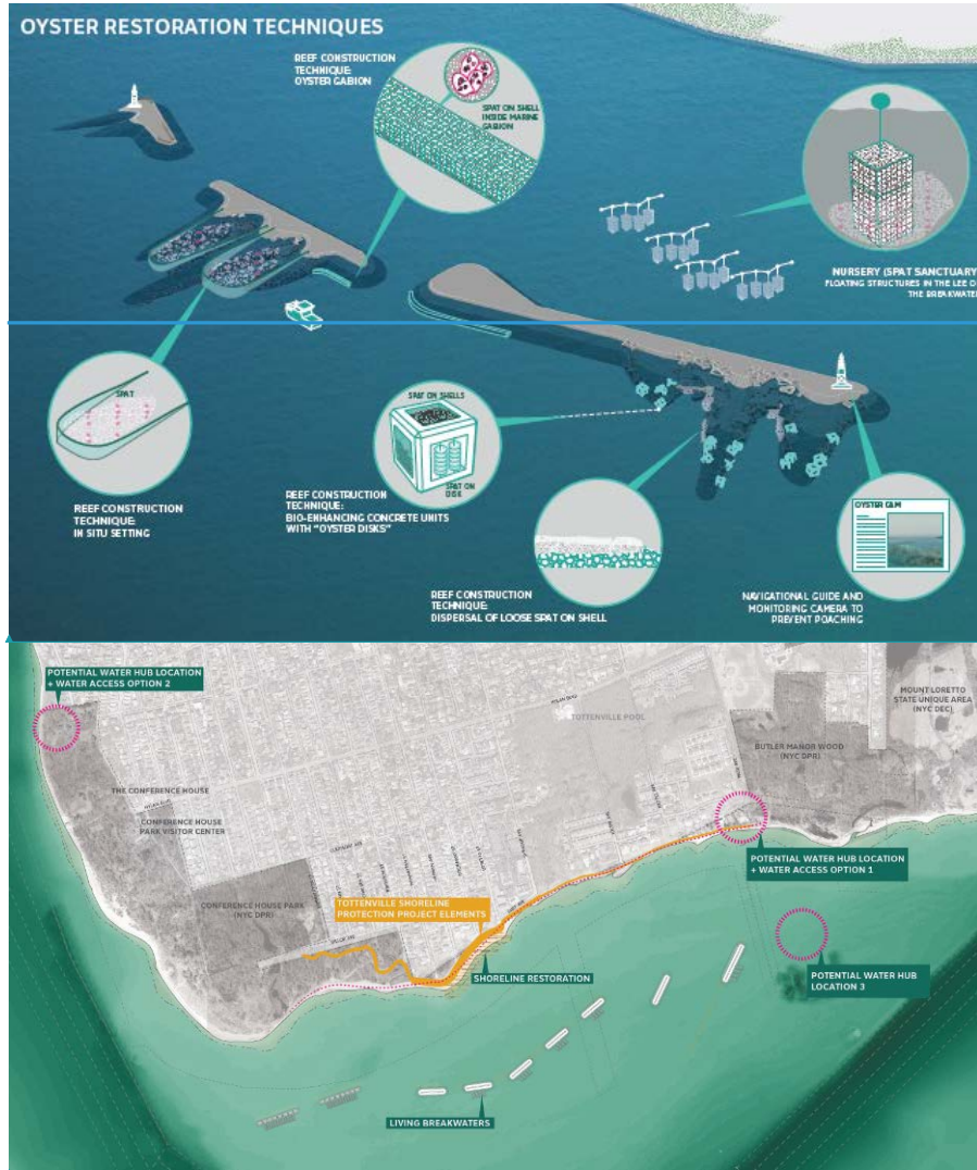
图 5: 提议的牡蛎恢复技术在初步 60% 设计的活动防波堤
